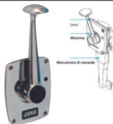
**69.810.00** Progettato in esclusiva per Lewmar, questo controllo motore è di tipo non magnetico, quindi può essere montato sulla colonnina o a paratia senza interferire con la bussola. Fabbricato in acciaio inox 316, dotato di leva dritta e di pulsante di innesto folle.
